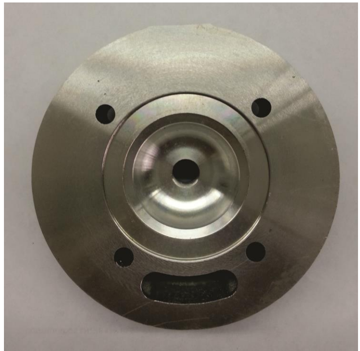
Foto de la camara de combustión
